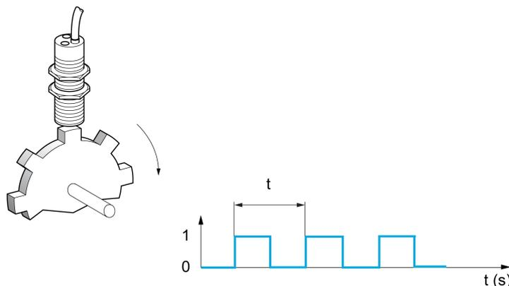
Appliqué à l'entrée Pulse input, ce signal offre les possibilités suivantes :
