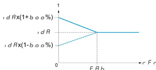
**NOTE** : Pour les moteurs synchrones, il est recommandé de régler cette valeur pour optimiser la commande à basse vitesse.
