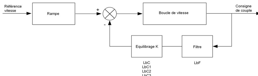
Le coefficient d'équilibrage de charge est déterminé par le couple et la vitesse, à l'aide des deux coefficients K1 et K2 ( $K = K1 \times K2$ ).
