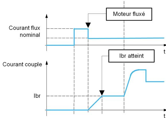
Quand l'ordre de marche est donné, le variateur surfluxe le moteur pendant une courte durée afin de générer un couple moteur suffisant. Le niveau du couple est réglé à l'aide du paramètre **[Courant dess. frein] i b r**. Ce couple est requis pour maintenir la charge pendant le desserrage du frein et avant de commencer la régulation de vitesse.
