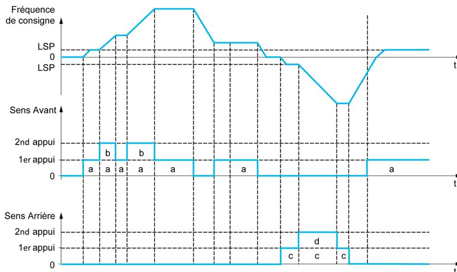
N'utilisez pas ce type de commande Vitesse +/- avec une commande 3 fils.
