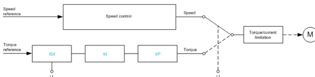
La fonction permet d'alternier entre le fonctionnement en mode de régulation de vitesse et celui en mode de régulation de couple.
