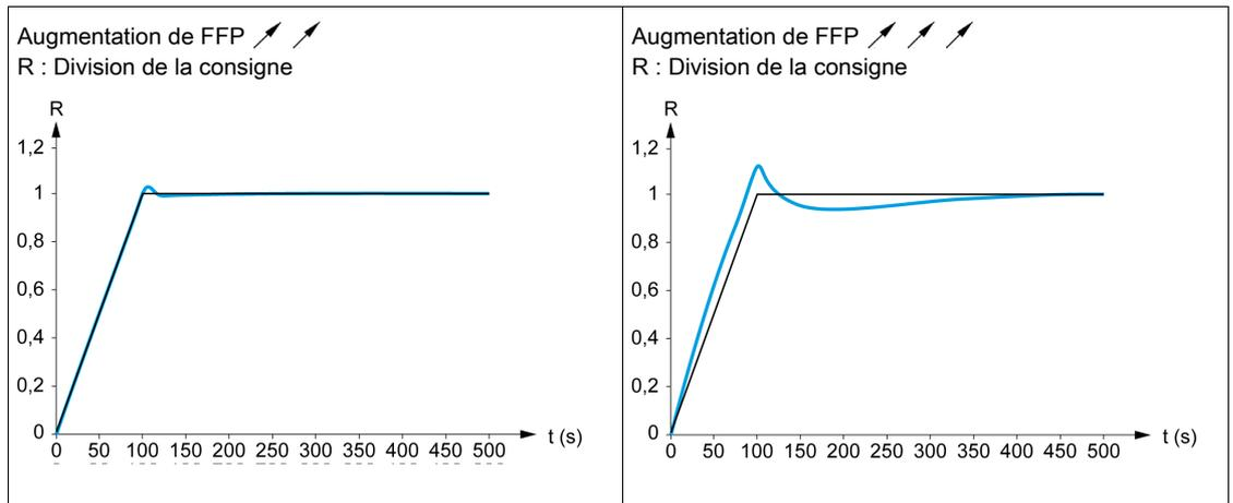
**Boucle de vitesse haute performance - Réglage du paramètre [B passante Feedfwd] F F V**
