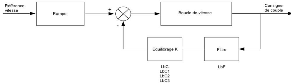
Le coefficient d'équilibrage de charge est déterminé par le couple et la vitesse, à l'aide des deux coefficients K1 et K2 ( $K = K1 \times K2$ ).
