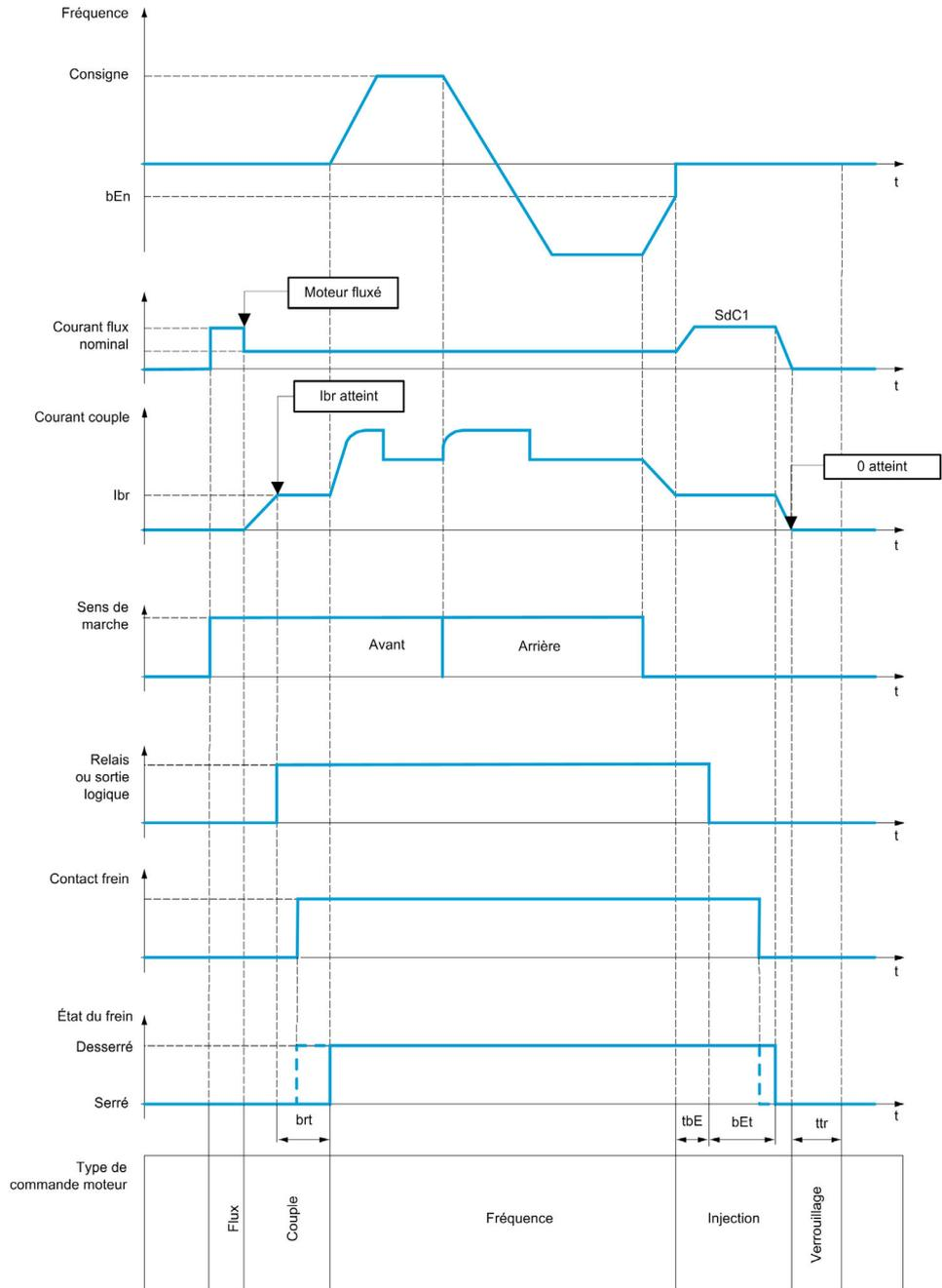
Mouvement vertical en mode boucle ouverte
