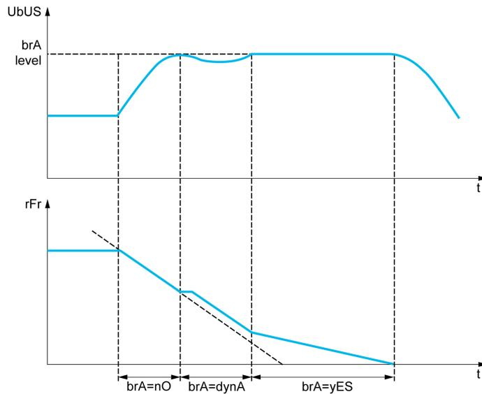
L'activation de cette fonction adapte automatiquement la rampe de décélération, si celle-ci a été définie à une valeur basse en fonction de l'inertie de la charge, qui peut entraîner le déclenchement d'une erreur de surtension détectée.
