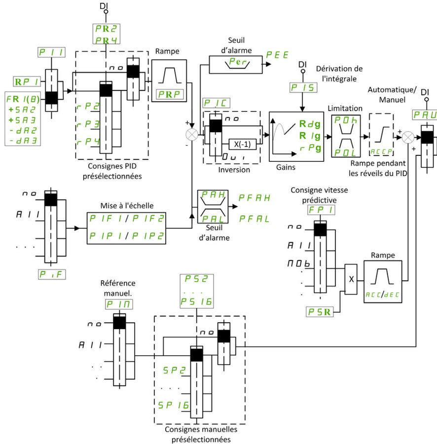
Le paramètre Retour PID doit être affecté à l'une des entrées analogiques AI1 à AI5 ou à une entrée impulsionnelle, selon que le module d'extension E/S a été inséré ou non.
