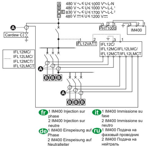
**fr** 1 IM400 Injection sur phase 2 IM400 Injection sur neutre
