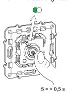
La lumière connectée au variateur rotatif clignote quelques fois. La LED d'état cesse de clignoter en vert sur l'interrupteur sans fil et le variateur rotatif. Le variateur rotatif peut désormais être commandé par l'interrupteur sans fil.
