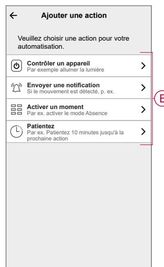
a. Dans cet exemple, nous allons d'abord sélectionner **Contrôler un appareil** et sélectionner **Variateur** (F) comme appareil déclenchant une action, puis nous sélectionnerons l'option **Patienter** pour ajouter un délai dans l'automatisme.
