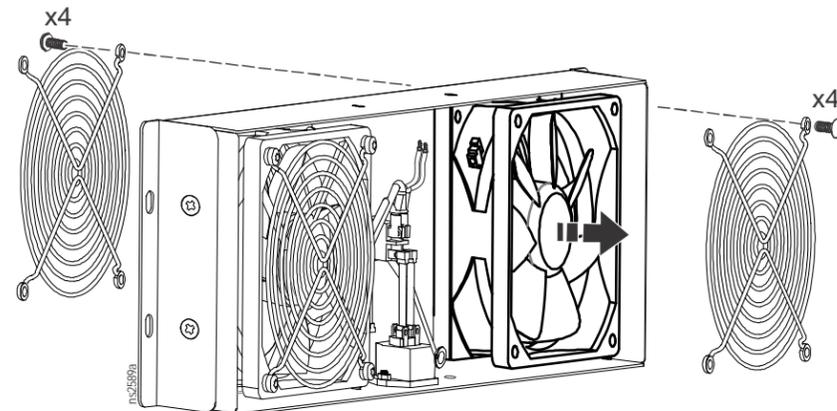
Install the new fan in the module
