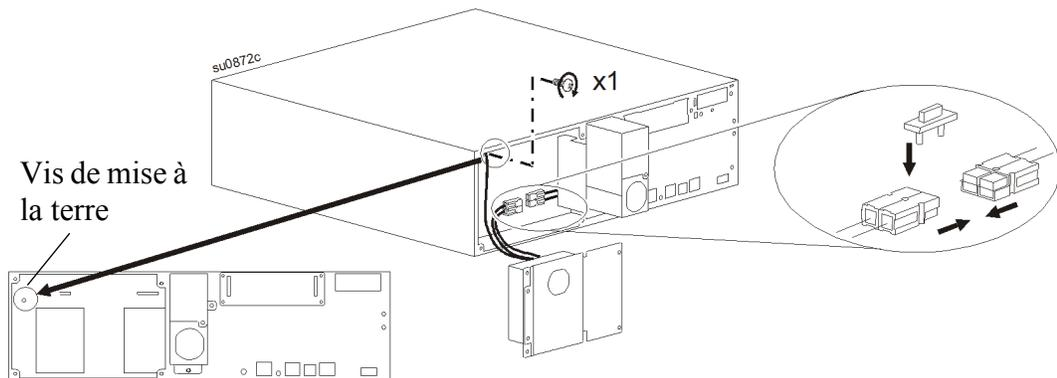
**2** Fixez le kit pour le câblage de sortie sur l'onduleur.
