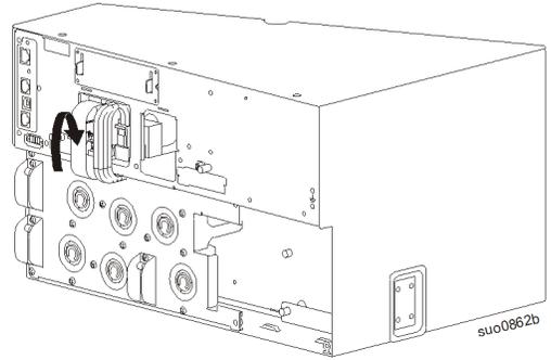
7 Installez le panneau d'accès arrière. Installez le boîtier de câblage CA.
