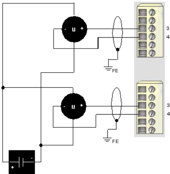
2 actionneurs analogiques non isolés, alimentation 24 VCC fournie par le PDM
