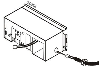
❹ Connectez ensemble les deux connecteurs de batterie. Placez les connecteurs de batterie dans le compartiment de la batterie.
