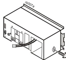
❸ Placez le câble de batterie externe et le serre-câble inclus dans la boîte avec la batterie.
