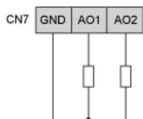
Les sorties AO1 et AO2 peuvent aussi être utilisées comme générateurs PWM, jusqu'à 2 kHz.
