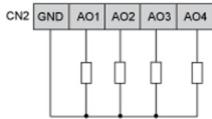
Les sorties AO3 et AO4 peuvent aussi être utilisées comme générateurs PWM, jusqu'à 2 kHz.
