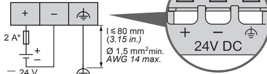
(\*): Type T fuse / Fusible de type T / Sicherung Typ T / Fusibile tipo T / Tipo de fusível T / T tipi sigorta / T 型熔断器 / Плавкий предохранитель типа T / T түріне жататын сақтандырғыш
