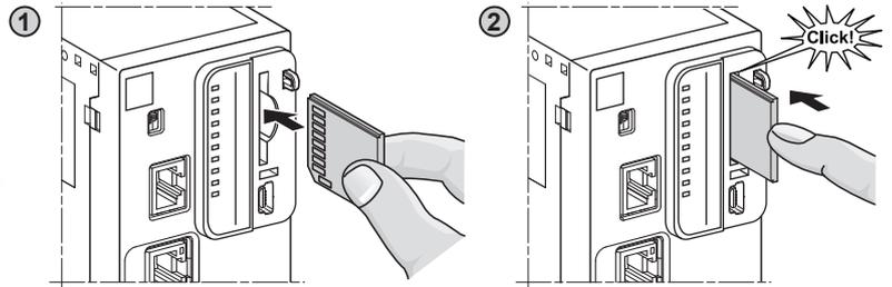
Battery installation / Installation des piles / Einsetzen der Batterie / Instalación de la batería / Installazione batteria / Instalação da bateria / Pil takma / 电池安装 / Установка батареи / Батареяны орнату
