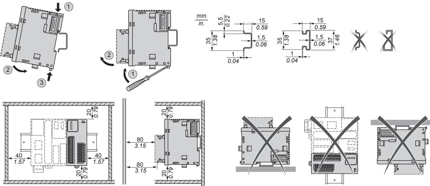
**Mounting on panel with attachment kit TMAM2 / Montage sur panneau avec kit de fixation TMAM2 / Befestigung auf der Monatgeplatte mit dem Montagesatz TMAM2 / 使用安装套件 TMAM2 安装到面板上。**
