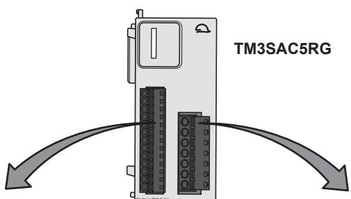
Spring terminal blocks 3.81 mm (0.15 in.) pitch / Borniers à ressort pas de 3.81 mm
