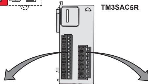
Screw terminal blocks 3.81 mm (0.15 in.) pitch / Borniers à vis pas de 3.81 mm
