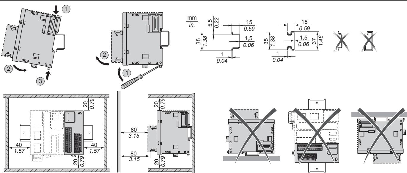
**Mounting on panel with attachment kit TMAM2 / Montage sur panneau avec kit de fixation TMAM2 / Befestigung auf der Montageplatte mit dem Montagesatz TMAM2 / Montaje en panel con kit de fijación TMAM2 / Montaggio su pannello con kit di fissaggio TMAM2 / 使用安装套件 TMAM2 安装到面板上。**
