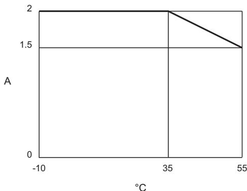
Si la restriction de dissipation des modules adjacents n'est pas possible dans votre configuration, la réduction de charge doit glisser de -5 °C (-9 °F), et on peut maintenir 2 A / sortie à 30 °C (86 °F). Dans la plupart des applications industrielles, il serait nécessaire de placer le module dans un boîtier climatisé pour préserver de telles températures.
