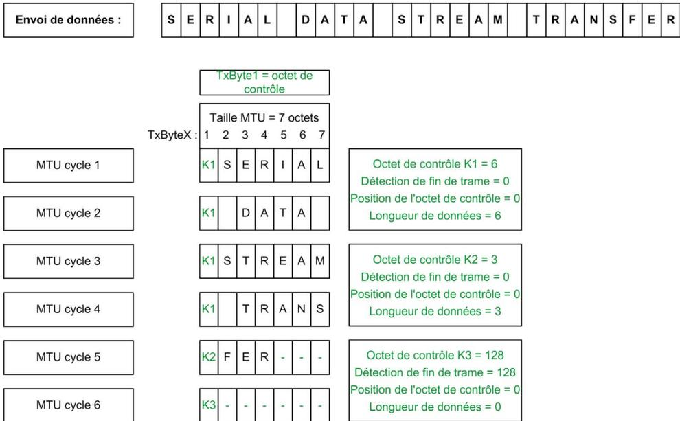
Le processus de préparation et de division des données de transmission est le même, que vous utilisiez ou non le mécanisme `Block Forward` :
