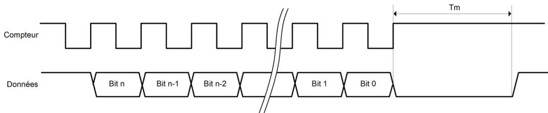
Dans l'exemple 2, le paramètre **Vérification monoflop** doit être configuré en niveau bas. Ceci garantit le report de la génération d'horloge après le passage de la ligne de données au niveau bas.
