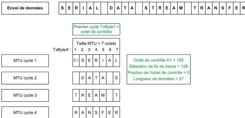
Contrairement à la figure de la section Transmission de données : préparation des données cycliques, organisation maximum et surveillance des étapes individuelles (*voir page 202*), cette action provoque l'enregistrement de deux cycles MTU pour la même longueur de trame et la même taille de la MTU. Une nouvelle trame peut débuter après la dernière MTU cycle 4.
