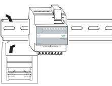
Insérez l'entrée binaire par le bas dans le rail puis poussez-la vers le haut. Poussez maintenant l'appareil vers le haut puis accrochez-le sur le rail (figure 2).
