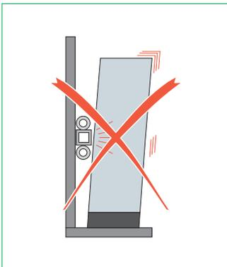
Aucun élément ne doit appuyer contre la face arrière de l'équipement.
