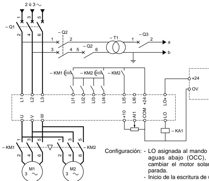
Configuración: - LO asignada al mando de contactor aguas abajo (OCC), para poder cambiar el motor solamente en la parada.
