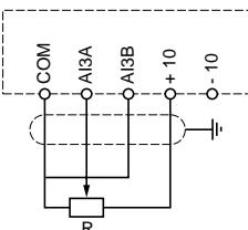
Zweipoliger Drehzahlsollwert bei einer externen  $\pm 10$ V-Versorgung oder Istwert der PI-Funktion
