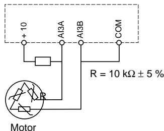
Ejemplo de esquema de conmutación de motores:
