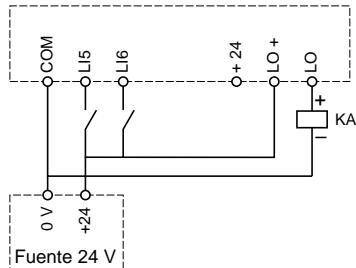
Protección del motor por sondas PTC
