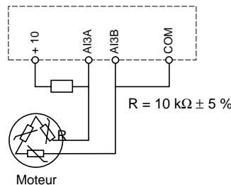
Exemple de schéma de commutation de moteurs :
