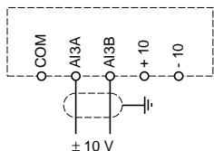
Drehzahlregelung mit Tachogenerator-Istwert
