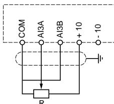
Consigna de velocidad bipolar en una alimentación externa  $\pm$  10 V o retorno de la función PI
