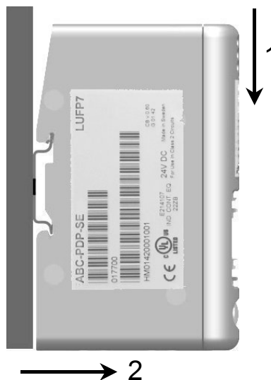
Démontage de la passerelle
