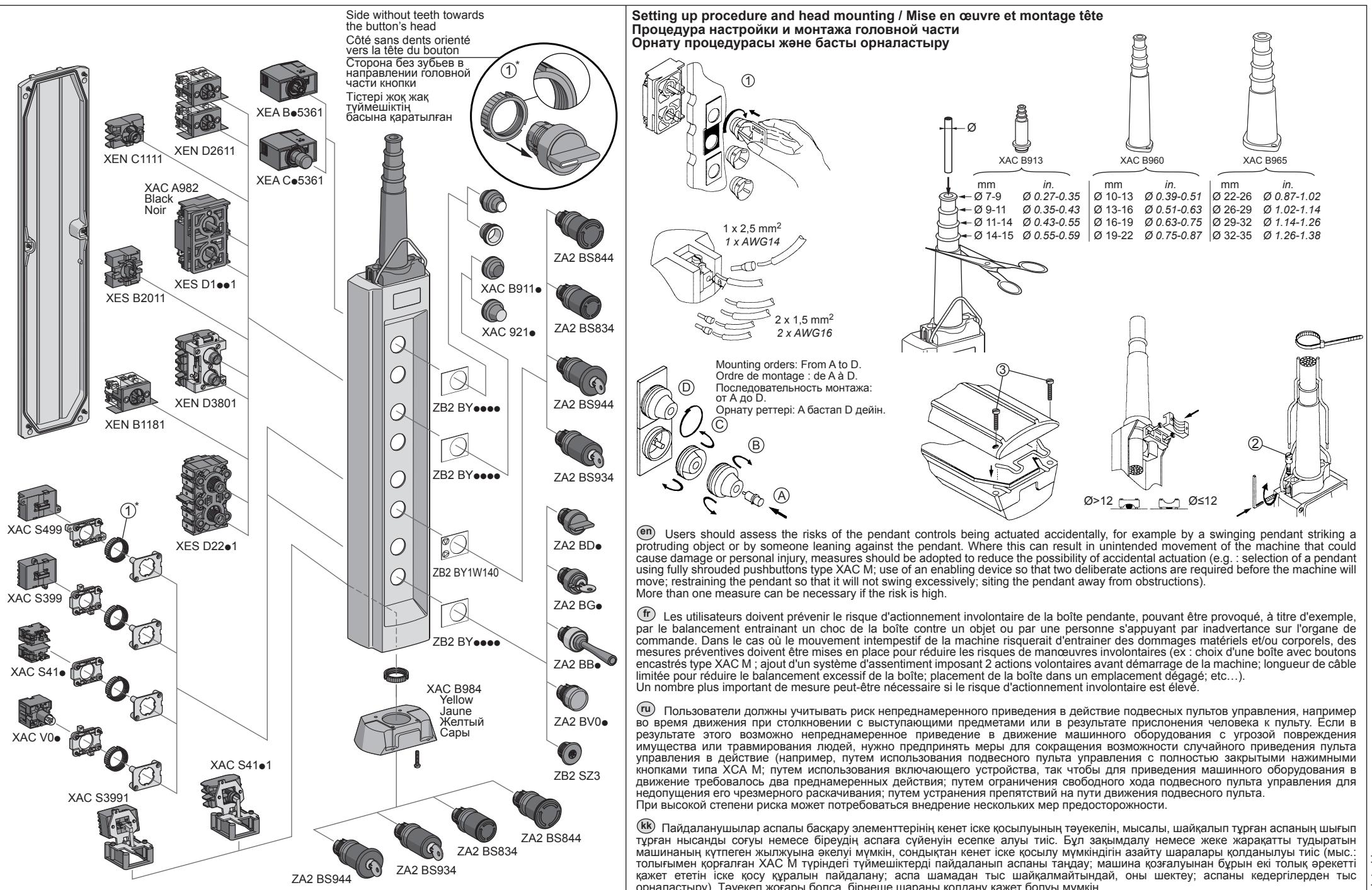
With emergency stop trigger action and mechanical latching pushbuttons / Avec boutons coup de poing d'arrêt d'urgence à verrouillage brusque et à accrochage mécanique
