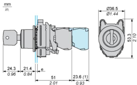
e : épaisseur du dispositif de serrage : 1 à 6 mm / 0,04 à 0,24 po.
