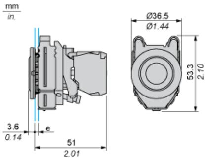
e : Epaisseur du dispositif de serrage : 1 à 6 mm / 0,04 à 0,24 po.
