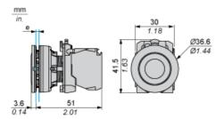
e: Epaisseur du dispositif de serrage: 1 à 6 mm / 0,04 à 0,24 po.
