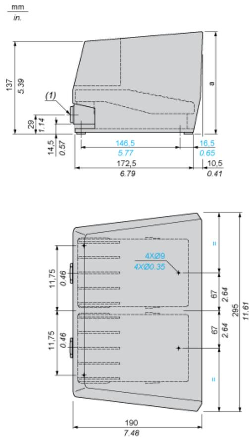
(1) 2 entrées taraudées pour presse-étoupe n° 16 (Pg 16). Pour ISO M20, utiliser un adaptateur DE9RA620.
