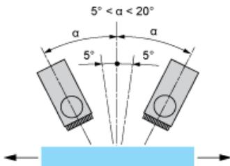
Un angle de 5 à 10° par rapport à la verticale est recommandé pour les surfaces réfléchissantes ou transparentes. Inclinaison verticale maximum : 20°
