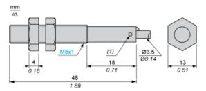
(1) Voyant, 4 ports de visualisation à 90° Rema@puepte de serrage de l'écrou de fixation : < 2 N.m
