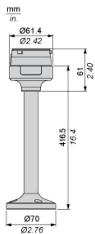
Montage des colonnes de signalisation modulaires
