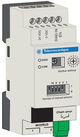
Le module de diagnostic interprète les données de diagnostic de l'ensemble de la chaîne de XCSR•2M12 reliés en série, et place ces informations dans des registres Modbus pour les rendre disponibles. Il identifie les dispositifs de protection ouverts et fermés, et empêche le redémarrage de la machine en cas de dysfonctionnement de la «Daisy Chain».
