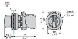
e: Epaisseur du dispositif de serrage: 1 à 6 mm / 0,04 à 0,24 po.
