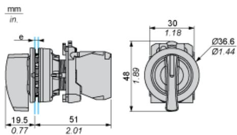
e : Epaisseur du dispositif de serrage : 1 à 6 mm / 0,04 à 0,24 po.
