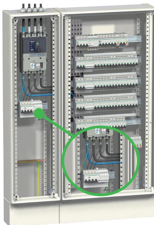
Armoire PrismaSeT avec jeu de barres Powerclip et gaine. Le conducteur de terre principal arrive par le bas. Le conducteur de terre du parafoudre est relié au plus près à la structure du coffret (veiller à s'assurer de la continuité de masse). Le parafoudre est installé dans la gaine au plus près de la protection de tête.
