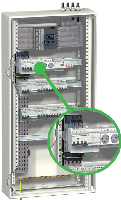
Coffret PrismaSeT avec jeu de barres Powerclip et arrivée de la terre principale par le bas. Le conducteur de terre du parafoudre est relié au plus près à la structure du coffret (veiller à s'assurer de la continuité de masse).
