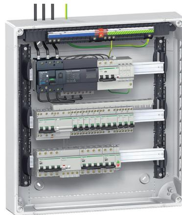
Coffret PrismaSeT XS avec arrivée de la terre principale par le haut et parafoudre en haut : le bornier de terre est déporté au plus près du parafoudre
