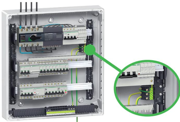
Coffret PrismaSeT XS avec arrivée de la terre principale par le bas et parafoudre en haut : un bornier intermédiaire de terre (réf. LV5XK6) est déporté au plus près du parafoudre
