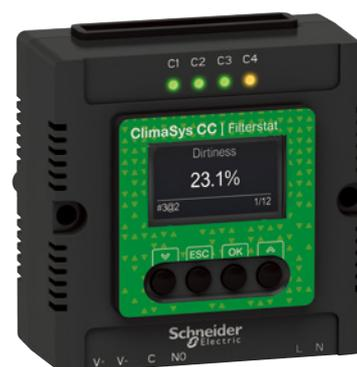
Le ClimaSys™ Smart Ventilation System est un réseau intelligent et intégré qui simplifie votre quotidien. Le coeur de ce système est le contrôleur Filterstat qui collecte les informations depuis les capteurs de ventilateur et d'encrassement des filtres dans l'ensemble de vos installations. Les algorithmes analysent l'ensemble de ces données, permettant à Filterstat de vous tenir informé de la situation thermique de chacune de vos installations.
