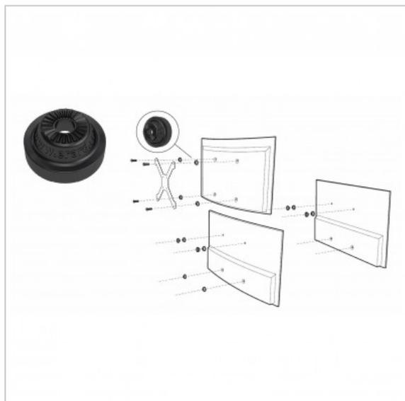
Le kit d'adaptation pour écrans incurvés et à dos irréguliers Erard contient un jeu de cales et les vis nécessaires à l'installation de ce type d'écran.
