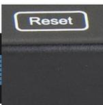
de chaque boîtier en enfonçant le bouton “ reset ” avec une aiguille pendant 10 secondes.
