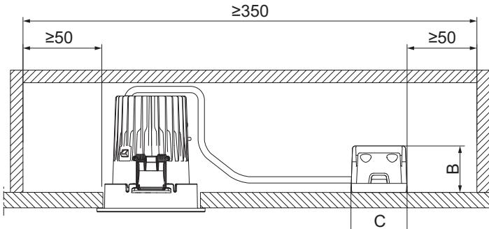
**DE** Leuchte darf nicht mit Wärmedämmung abgedeckt werden.
