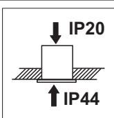
**FR** L'installation dans un plafond fermé est nécessaire pour qu'une réalisation soit IP 44. La protection IP 44 ne joue que par rapport à la pièce.
