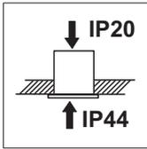
**DE** Voraussetzung für die Schutzart IP 44 der Leuchte ist die Installation in einer geschlossenen Decke! Die Schutzart IP 44 gilt nur von der Raumseite her.
