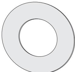
**DE** Bei dünnem oder weichem Deckenmaterial empfiehlt sich die Verwendung des Deckenverstärkungsringes zur Vergrößerung der Auflagefläche!
