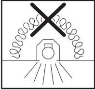
**DE** Leuchte darf nicht mit Wärmedämmung abgedeckt werden.
