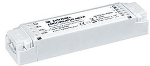
L'APDX-500 peut être commandé par signal DSI ou DALI. Il est compatible avec les lampes halogènes TBT et les lampes à incandescence. Dans ces cas, il ne peut être utilisé qu'avec des transformateurs électroniques. L'APDX-500 ne peut pas être utilisé avec des lampes à incandescence ou des lampes à incandescence halogènes HT. L'APDX-500 ne peut pas être utilisé avec des lampes à incandescence halogènes HT.
