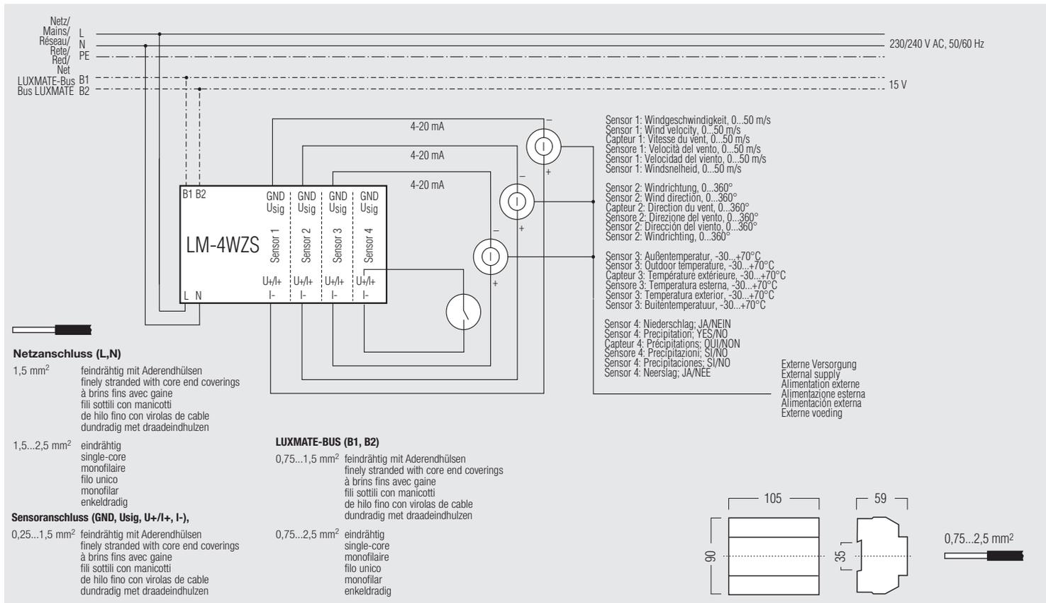
Gerät zur Auswertung von 4 voneinander unabhängigen Wetterstationssensoren zur Anbindung an den LUXMATE-Bus in zentral automatisierten Anlagen.
