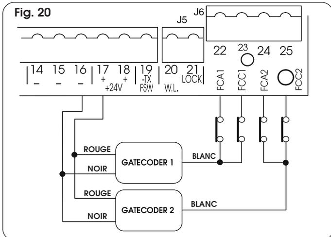
**N.B.:** Les configurations indiquées sur les dessins sont maximales. Toutes les configurations intermédiaires sont permises, en utilisant seulement certains éléments (seulement 1 Gatecoder, seulement 1 fin de course, 2 Gatecoder et 2 fins de course, etc.). Dans ce cas, ponter à la masse les entrées non utilisées.
