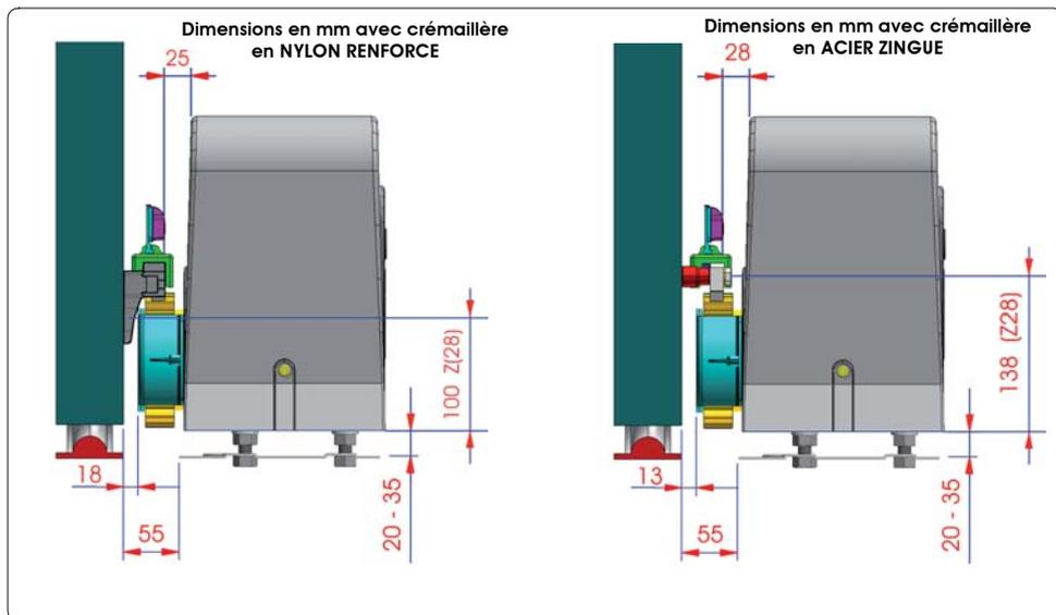
4. Fixer le motoréducteur à la plaque en serrant les écrous de fixation.
