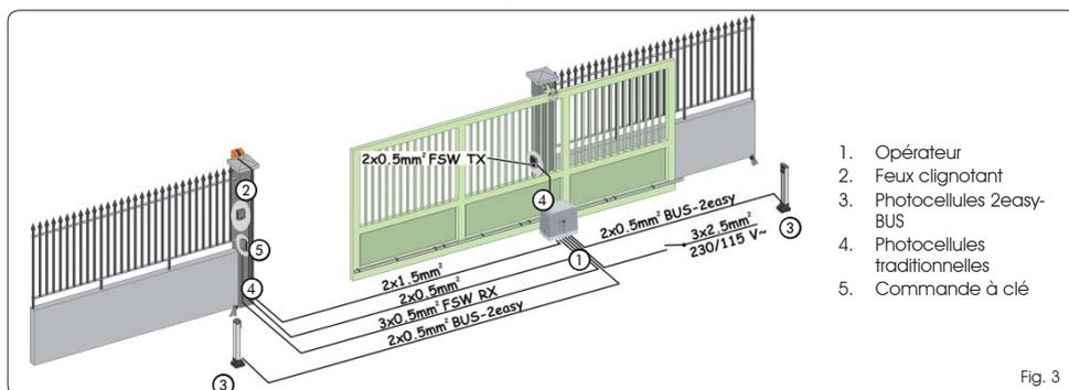
Les dimensions et les dispositions électriques (installation standard) sont les mêmes pour l'opérateur C720 et pour l'opérateur C721.
