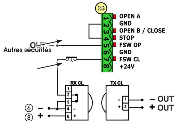
Branchement 1 paire de photocellules en fermeture avec sécurité FAIL-SAFE et STOP **désactivée**
