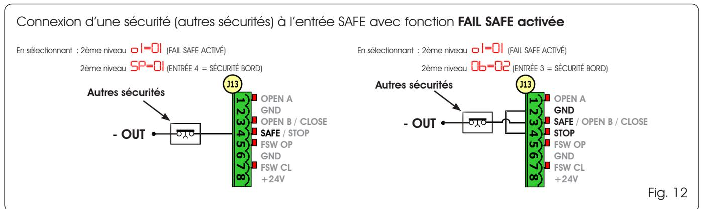
**En cas d'activation de la sécurité Fail Safe (paramètre configurable au 2ème niveau de programmation), le négatif à utiliser pour la gestion de l'entrée SAFE devra être - ⑥ (voir Fig. 13).**
