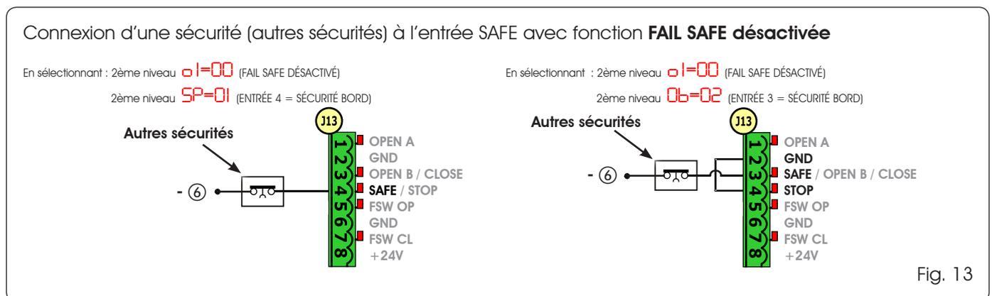
**Si l'on utilise les dispositifs avec un contact N.F. (Autres sécurités), ponter l'entrée SAFE au négatif -OUT avec FAIL SAFE activé ou à GND avec FAIL SAFE désactivé.**
