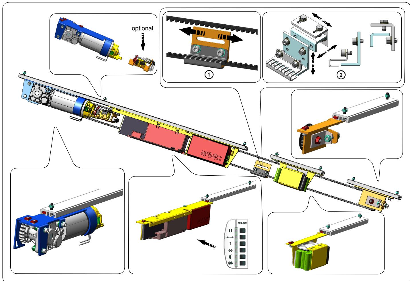
**Attenzione :** Prima del montaggio del Upgrade Kit RKU 140 , verificare lo stato del profilo di sostegno ,delle ante ,dei carrelli e del profilo di scorrimento .Verificare che la struttura meccanica sia adeguata e nei limiti previsti e in linea con le specifiche e caratteristiche del Upgrade Kit RKU 140.
