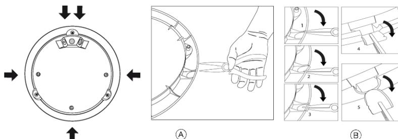
Percer un passe fils en son centre à l'aide d'une pointe. Ne pas utiliser de lame qui pourrait fragiliser le passe fils et nuire à l'étanchéité.
