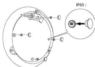
Pour la fixation du luminaire, utiliser des vis de diamètre 5mm à tête plate et des chevilles adaptées au type de paroi pour avoir une résistance optimale à l'arrachement. Les vis et chevilles ne sont pas fournies avec le luminaire. Positionner les 4 bouchons afin de respecter l'étanchéité du produit.
