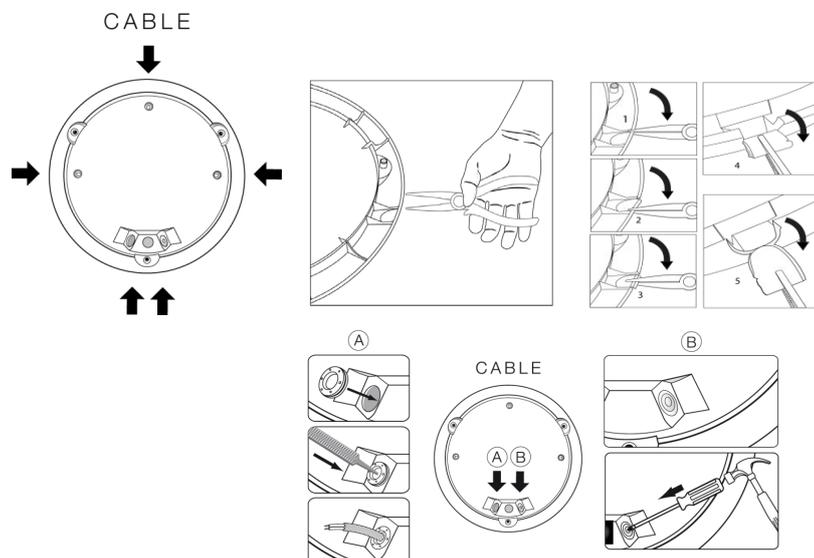
Pour une arrivée de câble latérale, utiliser les amorces de découpe présentes sur la base du luminaire. Afin de garantir l'étanchéité du luminaire l'utilisation des passes-fils est impérative. Utiliser un câble de type U1000R2V 1.5mm<sup>2</sup> (préconisé pour le respect de l'étanchéité).
