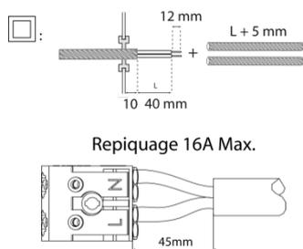
Le câble devra être dénudé selon schémas. Les fils devront être dénudés sur une longueur de 12mm. Les gaines de protection fournies dans le kit devront être enfilées sur les fils pour le respect de la classe II. Respecter la polarité.
