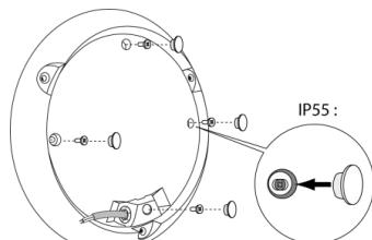
Pour la fixation du luminaire, utiliser des vis de diamètre 5mm à tête plate et des chevilles adaptées au type de paroi pour avoir une résistance optimale à l'arrachement. Les vis et chevilles ne sont pas fournies avec le luminaire.
