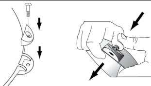
Positionner les 3 caches vis et clipser les vis sur le diffuseur.
