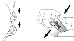
Positionner les 3 caches vis et clipser les vis sur le diffuseur.
