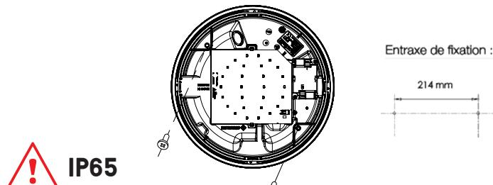
Pour la fixation du luminaire, utiliser des vis de Ø 4 - 4,5mm à embase non striée Ø 8,5 minimum ou ajouter une rondelle d'étanchéité (type EPDM 50 d4,5 x D11 x 1,5mm) sous la tête de vis. Utiliser des chevilles adaptées au type de paroi pour avoir une résistance optimale à l'arrachement.
