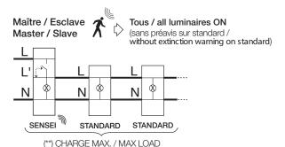
Tous / all luminaires ON Maître / Esclave / Maître (sans préavis sur standard / Master / Slave / Master without extinction warning on standard) (8) ⊗ (8) SENSEI STANDARD STANDARD SENSEI STANDARD (\*\*) CHARGE MAX. / MAX LOAD
