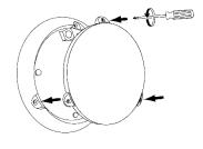
Avant de fermer le diffuseur revisser le réflecteur en suivant les étapes A, B et C.
