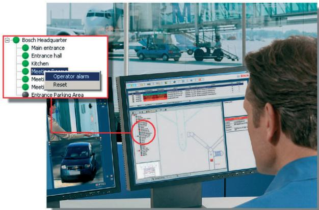
La fonction d'**alarme de l'opérateur** permet à un opérateur de déclencher une alarme manuellement à partir de l'arborescence d'emplacement, par exemple, s'il est informé par téléphone d'une situation dangereuse. Ces alarmes manuelles sont traitées de la même façon que celles déclenchées par un détecteur, ce qui signifie que les documents associés sont affichés et que toutes les étapes sont enregistrées dans le journal des événements pour une enquête post-événement plus approfondie.
